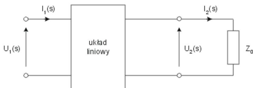
Rys. 15.1. Oznaczenie układu przy definicji transmitancji
